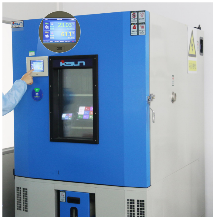
图 5-3 高低温老化测试图
