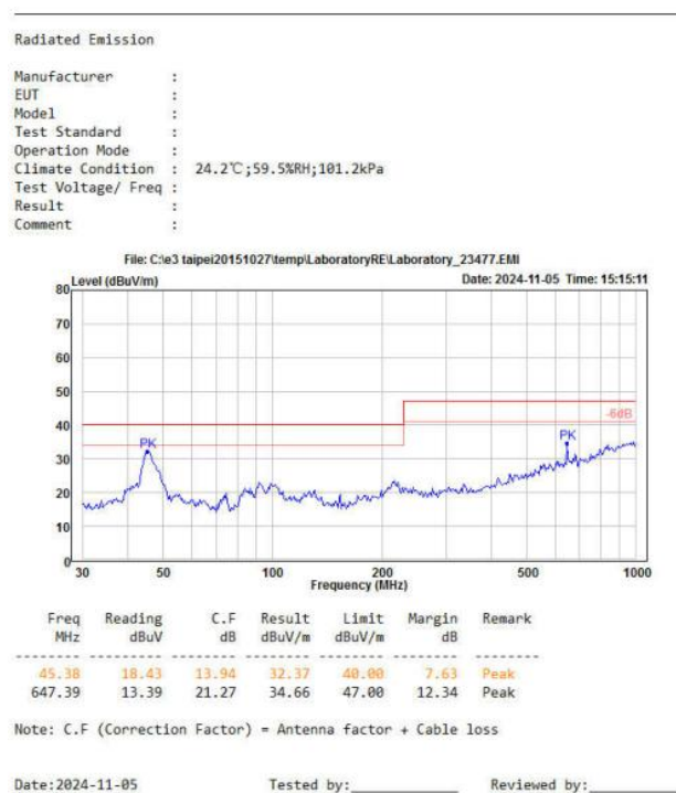
图 5-7 辐射测试垂直方向
